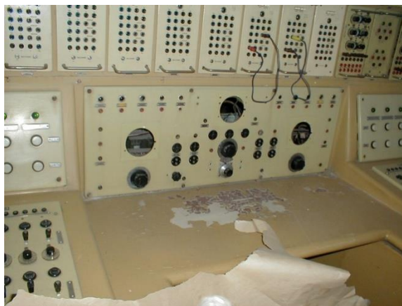
Analógový počítač SAV v depozitári Slovenského technického múzea v Košiciach v r. 2002. Vpravo vidieť otvory po chýbajúcich meracích prístrojoch.
