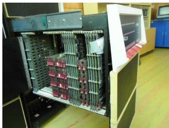
Počítač PDP-11/40 v expozícii Stálej výstavy a dosky procesora, pamäte a riadenia periférií
