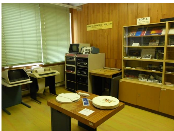
Počítač PDP-11/40 v expozícii Stálej výstavy a dosky procesora, pamäte a riadenia periférií
