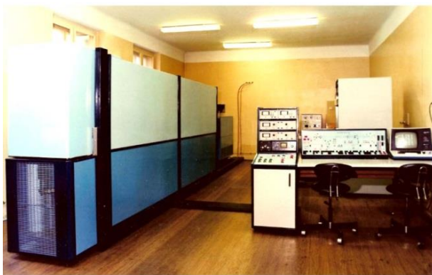
Obr. 7 Zostava iónového implantátora s jeho riadiacim pultom a riadiacim počítačom, v úzadí.
