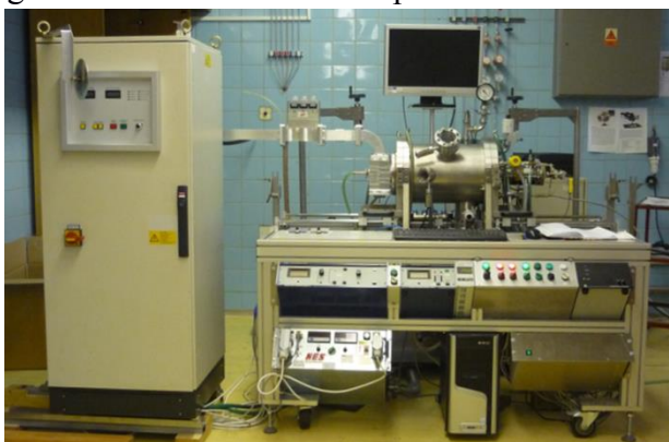
Obr. 14. D2-reaktor MW CVD na rast diamantových polykryštalických vrstiev
