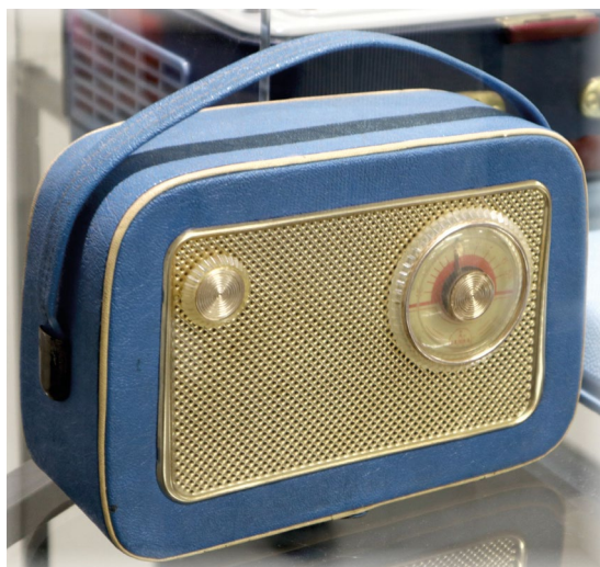
Tranzistorový prijímač T58 vyrobený v roku 1958 v Tesla Přelouč bol vystavený na Expo 1958 v Bruseli. Boli v ňom použité zliatinové tranzistory rady 1NU40, 1NU70 a 101–104NU70. Fotografia: J. Valenta
