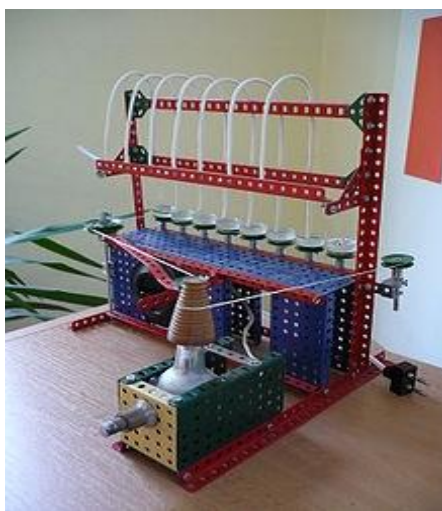
Obr. A Aparatúra O. Wichterleho zo stavebnice Merkur na odstredivé odlievanie kontaktných šošoviek.
