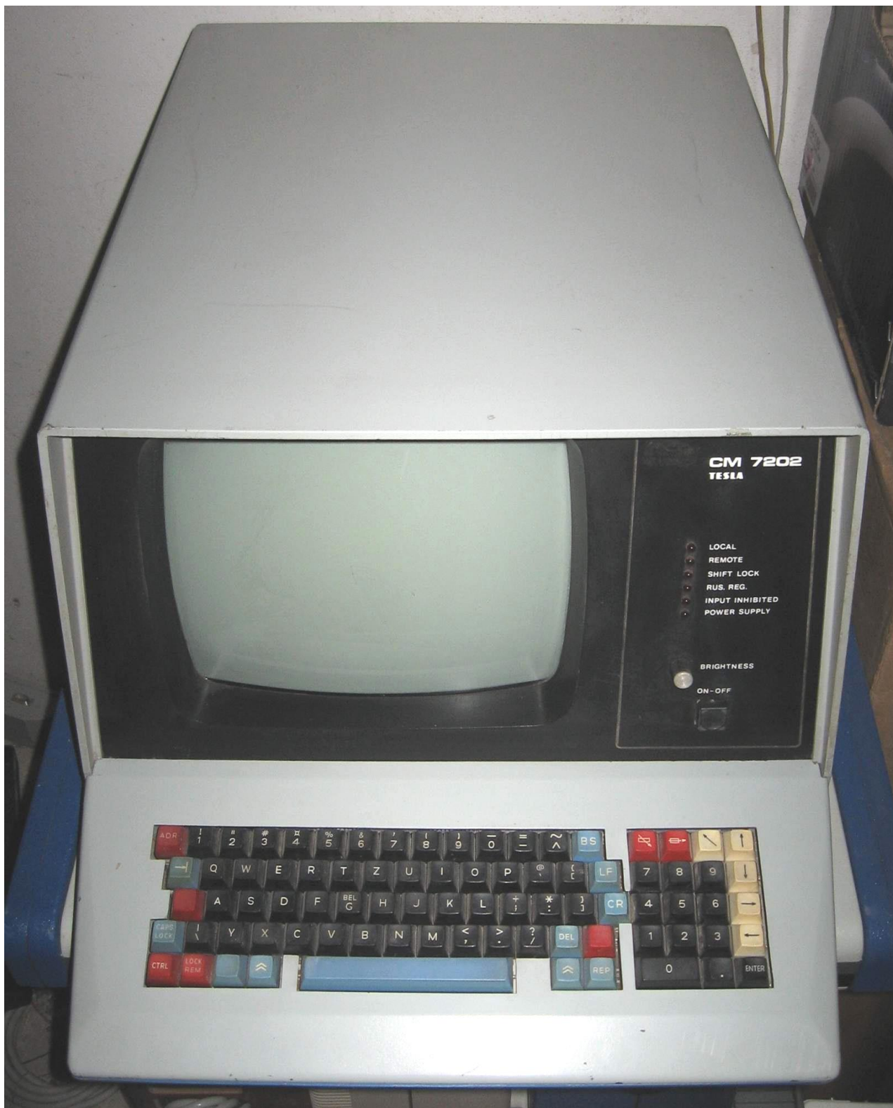
Obrázok 1. Prvé zariadenie, vyvinuté vo VVL Žilina v programe SMEP, bol tento abecedno číslícový videoterminál CM 7202. Na svoju dobu mal pokrokovú kompaktnú konštrukciu, umožňoval zobrazovanie znakov v rastrí 80 znakov na riadok a 24 riadkov na obrazovku. Umožňoval lokálne pripojenie k počítaču cez medzistyk IRPR alebo vzdialené pripojenie cez medzistyk IRPS resp. cez asynchrónny modem podľa normy CCITT V.24. Úspešné medzinárodné skúšky absolvoval v 9/1978.
