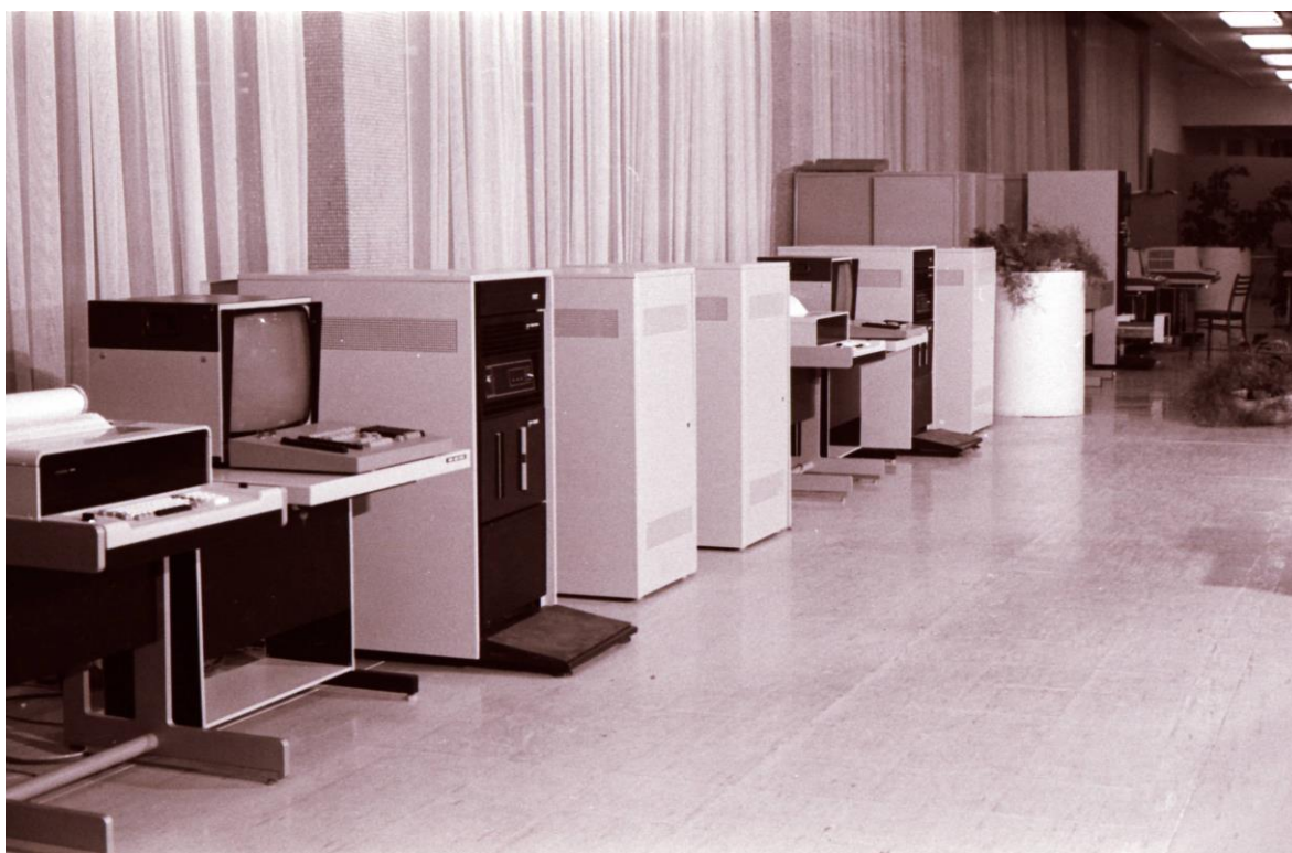
Obrázok 4. Skúšobná zostava distribuovaného multimikropočítačového riadiaceho systému SM 53_10 pre riadenie výrobných procesov. Vľavo je zostava TOP (tlačiareň, farebný semigrafický displej s operátorskou klávesnicou, v nízkom 19" stojane rošt procesora a rošt pružných diskov), vpravo dve zostavy TSP, všetky prepojené navzájom magistralou ILPS. V r. 1983 bol komplex SM 53/10 na Medzinárodnom strojárskom veľtrhu v Brne ocenený Zlatou medailou.
