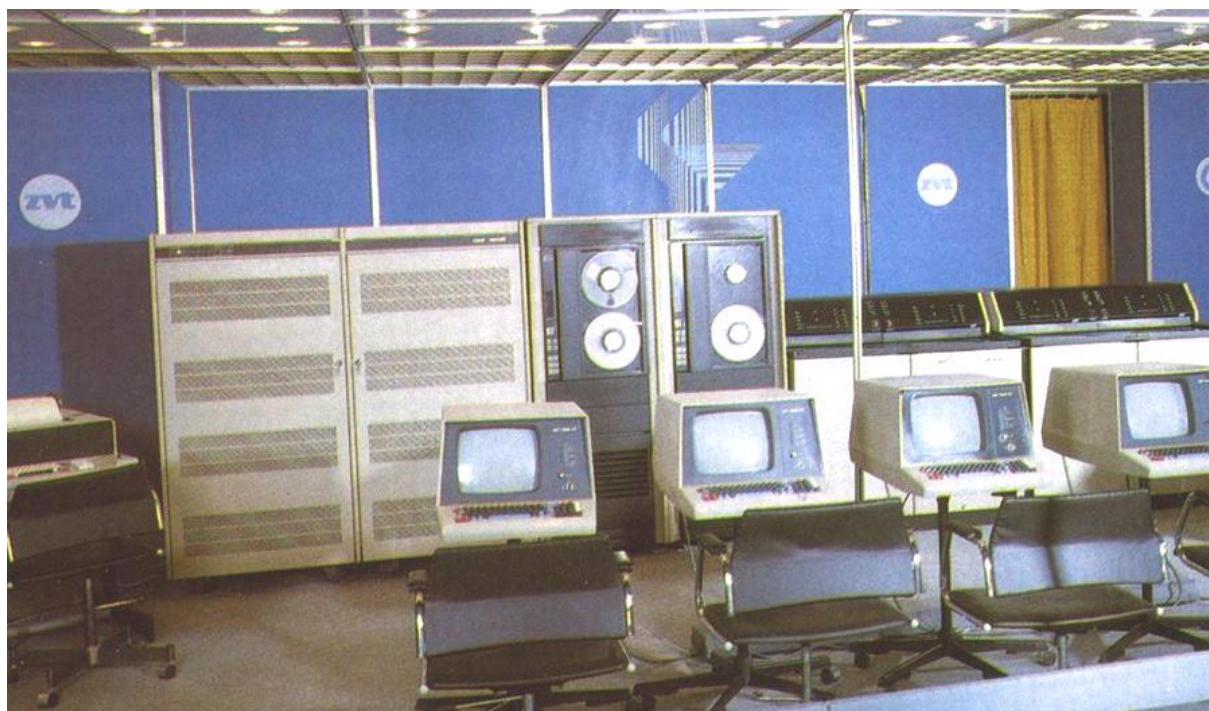
Obrázok 10. Na obrázku je zostava 32-bitového výkonného minipočítača SMEP SM 52/12 s dvoma mechanizmami diskových pamätí 2x100 MB, dvoma mechanizmami 1/2" magnetických páskových pamätí a viacerými videoterminálmi. Počas Medzinárodného strojárenského veľtrhu v Brne v r. 1986 mu bola udelená Zlatá medaila (obrázok dolu).
