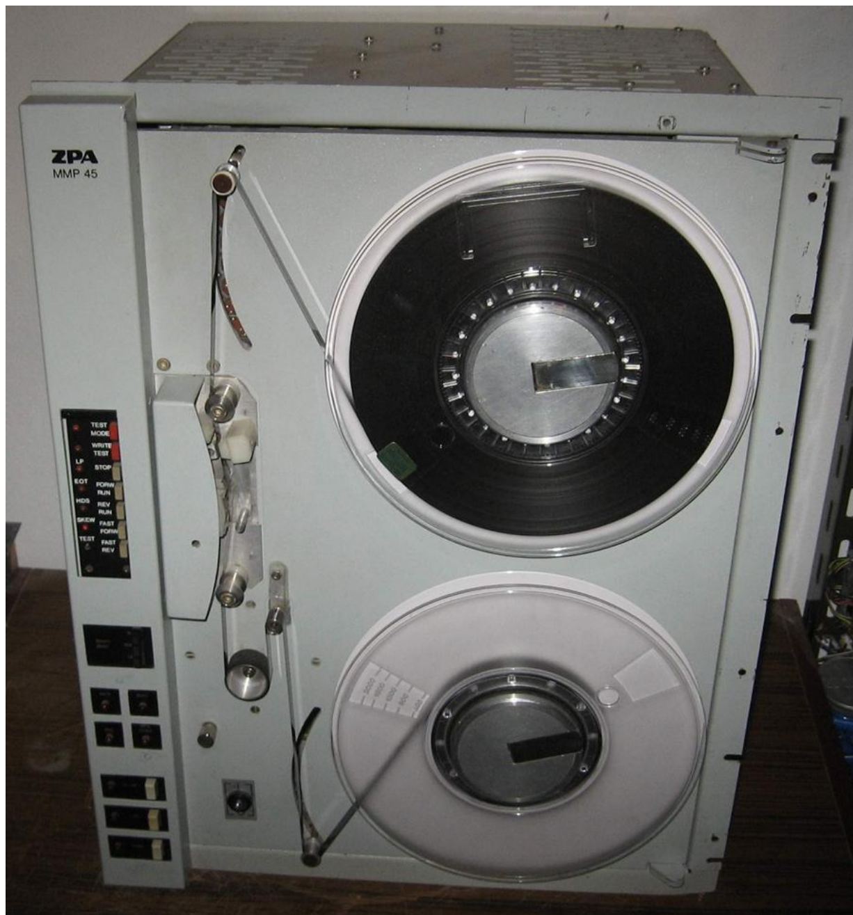
Obrázok 5. Magnetická pásková pamäť MMP 45 - CM 5311 bola prvým náročným elektromechanickým prídavným zariadením, vyvinutým vo VUVT Žilina v programe SMEP. Bola určená k uchovávaní dát na ½“ magnetickej páske záznamom NRZ-I aj PE, rýchlosť aktívneho pohybu pásky bola 45 ips, rýchlosť prenosu dát bola 36 KB/s pri zázname NRZ-I, resp. 72 KB/s pri zázname PE. Výrobu realizoval k.p. ZPA Prešov. Na MSV v Brne v r. 1983 bola táto pásková pamäť CM 5311 ocenená Zlatou medailou.
