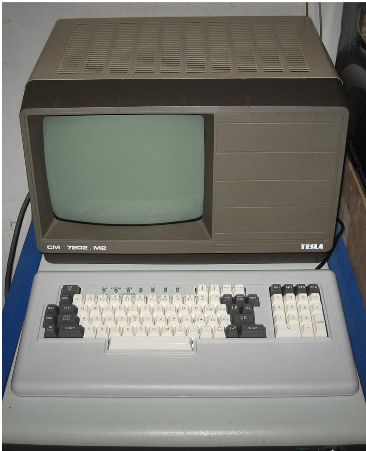
Obrázok 7. Inovovaný abecedne číslicový a grafický video terminál CM 7202 M.2, vyvinutý vo VUVT Žiline v programe SMEP III. Mal kompaktnú konštrukciu a pohodlnú oddeliteľnú klávesnicu, umožňoval zobrazovanie znakov v rastri 80 alebo 132 znakov na riadok a 24 alebo 16 riadkov na obrazovku. Umožňoval tiež zobrazovanie znakov malej a veľkej abecedy a pripojenie cez medzistyk IRPS resp. cez asynchrónny modem podľa normy CCITT V.24. Úspešné medzinárodné skúšky absolvoval v r.1985.
