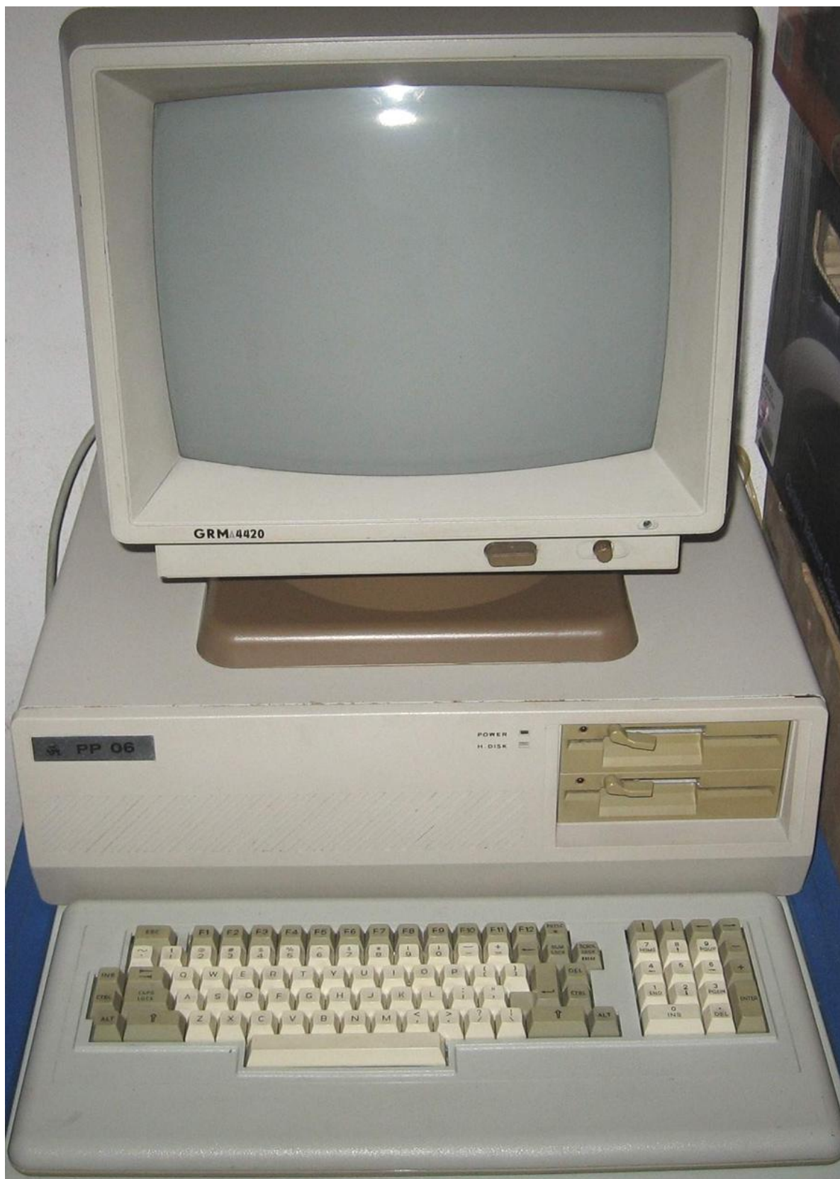
Obrázok 8. Na obrázku je 16 bitový personálny počítač PP 06 (CM 1912), kompatibilný s IBM PC resp. IBM PC XT. Vyrábala sa aj v prevedení PP 06.3 (CM 1922) - profesionálna grafická stanica, kompatibilná s IBM PGA so samostatným grafickým procesorom a grafickou pamäťou a PP 06.4 - laboratórny merací systém s podsystémom laboratórnej jednotky styku s prostredím (L JSP).
