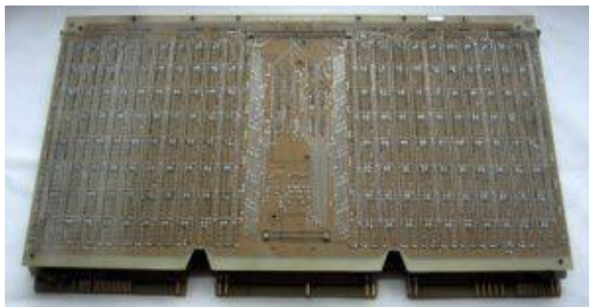
Obr. 10: Zostavená POP 256 KB ECC pre počítače SMEP SM 4-20 a SM 52/11, ktorej bola po úspešných medzinárodných skúškach pridelená šifra CM 3511.
