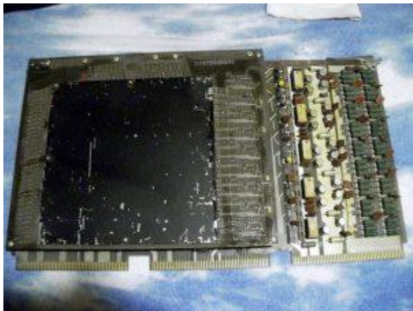
Obr. 8: Pohľad na samotný pamäťový „kváder“ 8K18 so súradnicovými výberovými diódami a integrovanými snímacími zosilňovačmi pre pamäťový modul 8K18 z FOP CM 3103
