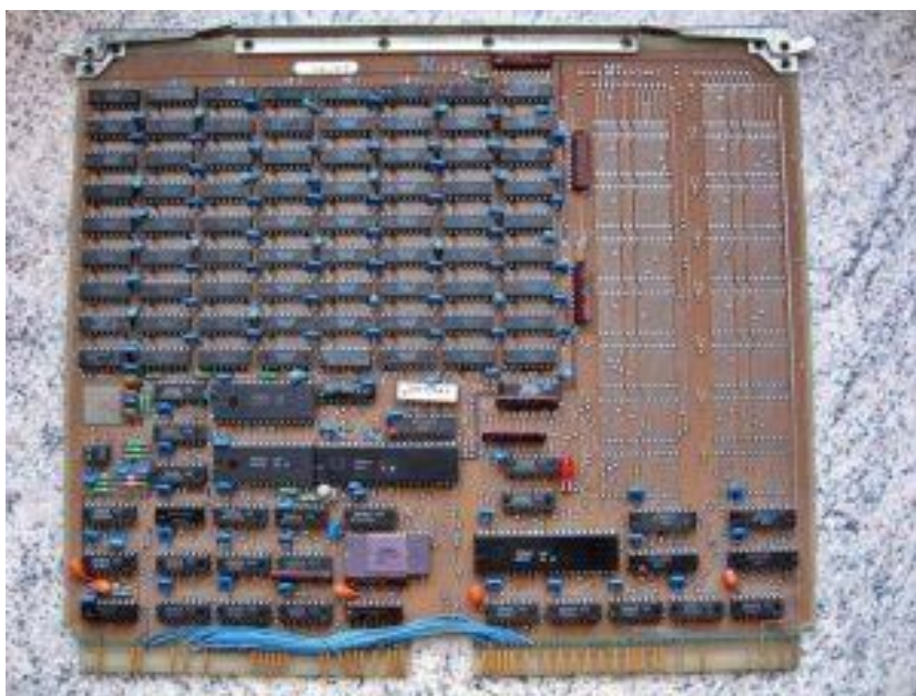
Obr. 16: Doska kombinovanej pamäti DRAM a EPROM, vyvinutá pre mikropočítač M 16-22, ktorý umožňoval adresovať OP do 4 MB.
