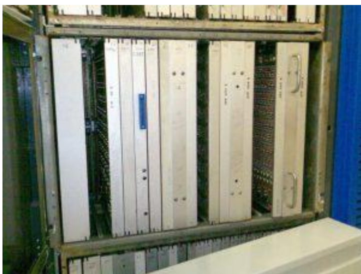
Obr. 5: V pravej časti obrázku je názorne vidieť priestorovú úsporu, získanú prechodom z priestorového pamäťového kvádra 4K20 na planárny pamäťový „kváder“ 4K18. Dosky súradnicových výberov v tejto fáze zostali bezo zmeny.
