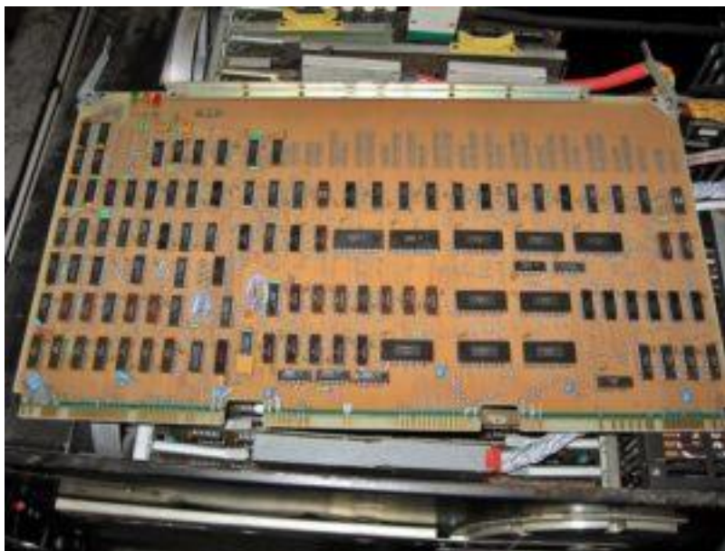
Obr. 15: je pohľad na dosku riadenia POP CM 3511 M.1 typu ECC. K doske riadenia bolo možné pripojiť 1 až 8 dosiek pamäťového poľa s prvkami 4116 alebo 1 až 4 dosky pamäťového poľa s prvkami 4164. Maximálna kapacita pamäti bola 4 MB.
