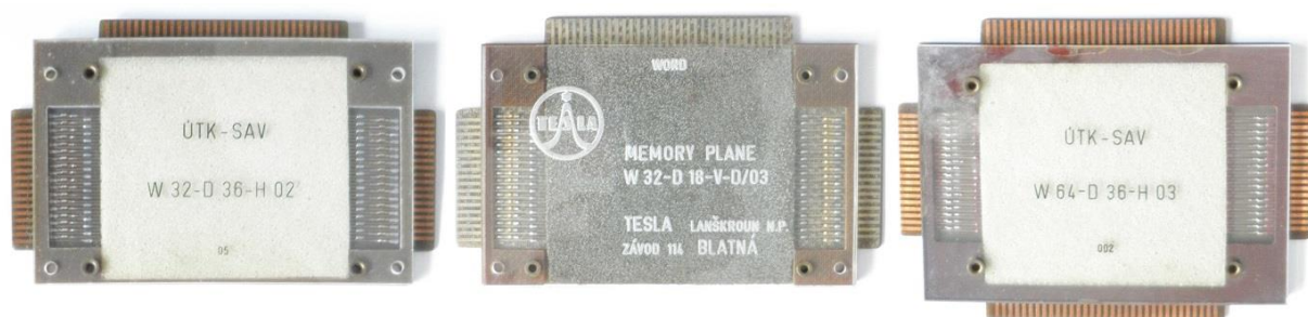
Obr. 2: Pamäťové matice zhotovené v ÚTK SAV a vyrobené v závode Tesla Blatná
