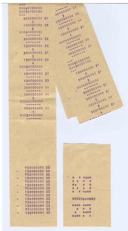
Obr. 3: ZRA-1 – výstup z tlačiarne počítača. Tlačili sa len čísla a niekoľko oddelovacích znakov. Výsledné hodnoty boli v tvare (mantisa) a (exponent+20)
