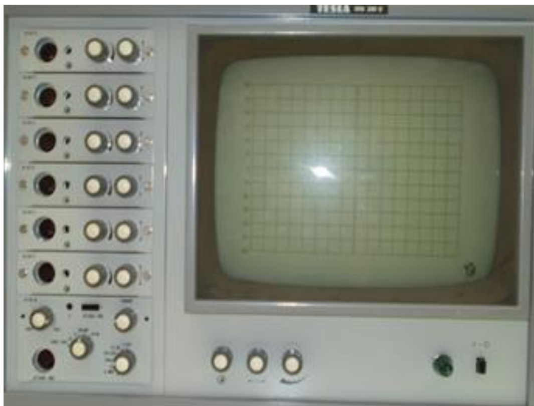
Obr.3: Pomalobežný osciloskop TESLA OPD 280U (1970) ako výstupná jednotka analógového počítača
